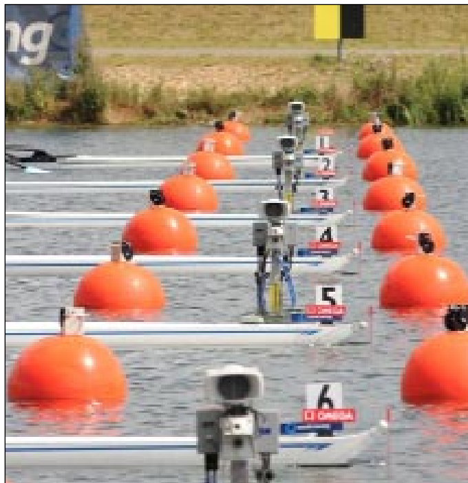
Le système de sabots utilisé pour les départs lors des Mondiaux juniors. Sabots beaucoup plus petits que les anciens.
