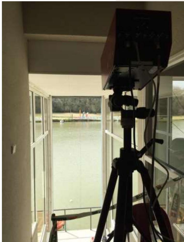
**Ces caméras permettent de départager formellement les équipages grâce aux « photos finish »**
